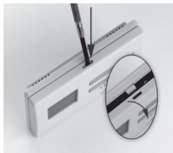
Le support des batteries est situé à l'intérieur de la plaque avant du revêtement. Selon la polarité indiquée, 2 piles AA (type LR6) doivent y être placées. Insérez-y ces deux batteries en respectant les polarités indiquées.
