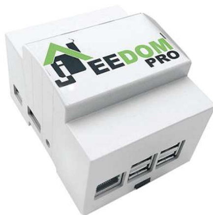
Box Jeedom Pro à installer dans un tableau électrique ou dans une baie de brassage réseau.
